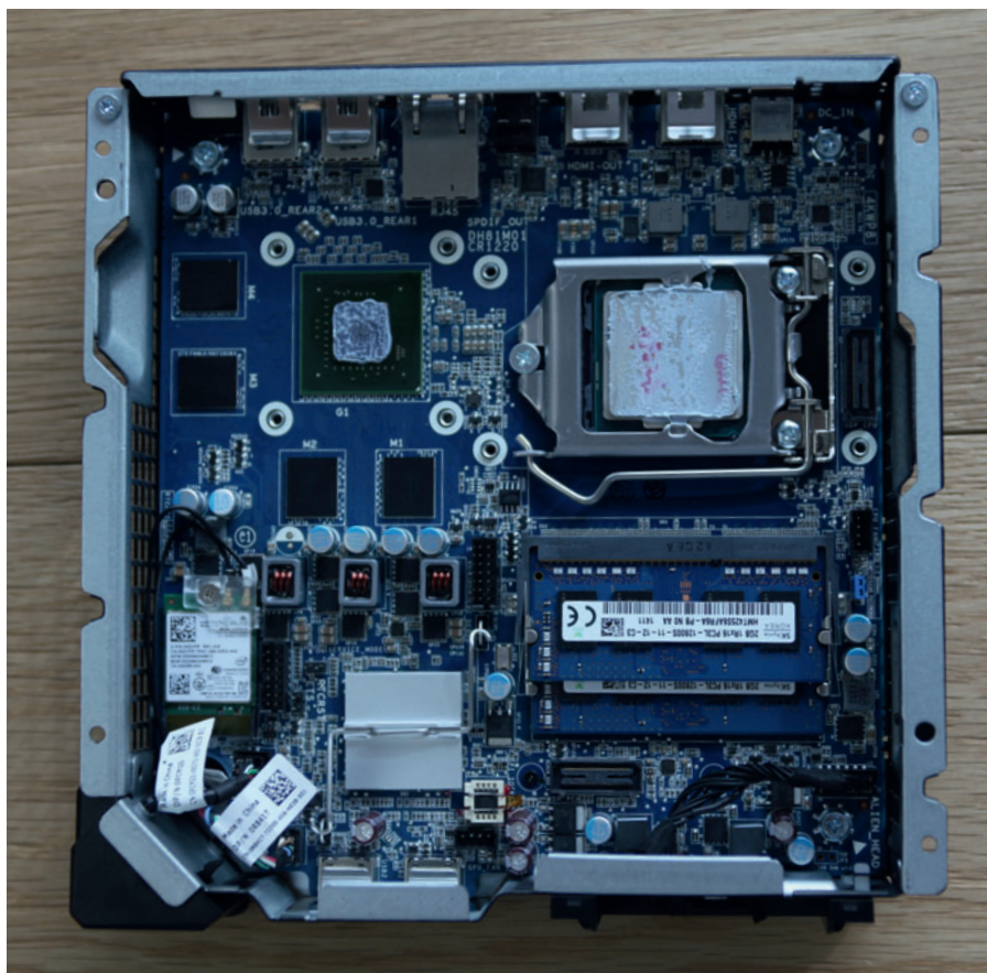
Внутри корпуса Alienware Alpha находится системная плата, сделанная на заказ
